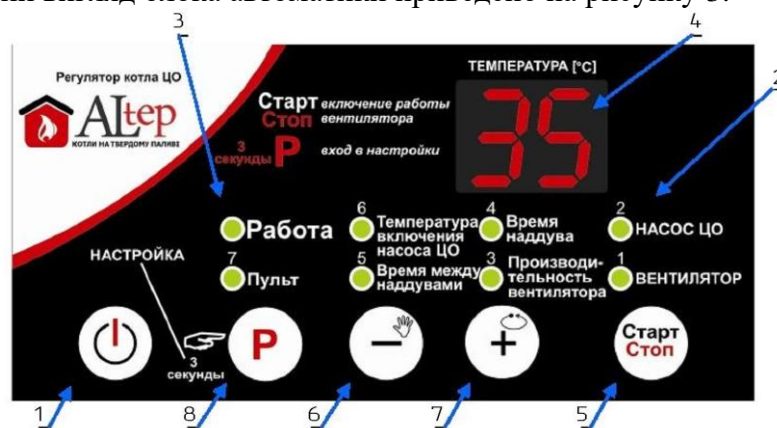
Рисунок 3 – Зовнішній вигляд передньої панелі контролера
